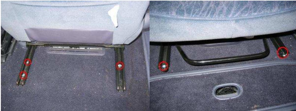
Sitz ganz nach vorne schieben und die 3 hinteren Schrauben in den Sitzschienen entfernen.
