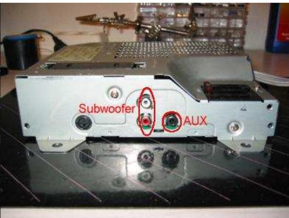
Unter der Abdeckung sieht man nun das Radio. Es ist mit 3 Sechskantschrauben befestigt (1 vorne, 2 hinten). An die hinteren Schrauben kommt man wieder nur mit einem Winkelschlüssel dran. Alle Kabel abziehen (brauchen nicht markiert werden, da alle Stecker unterschiedlich sind, man kann also später nichts verkehrt anstecken) und Radio ausbauen.
