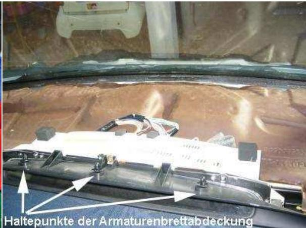
Jetzt kann man die Riesige Armaturentafel abnehmen, dazu die drei Befestigungsclips durch vorsichtiges ziehen gegen die Fahrtrichtung und gleichzeitigem nach oben hebeln überlisten. (in den drei hellen Punkten steckten die Clipse).
