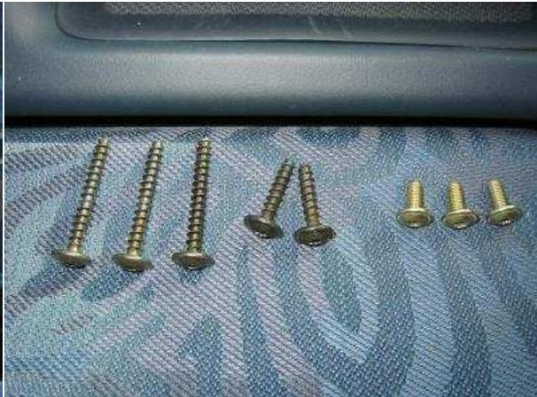
Um das LCD Display zu entfernen weitere 5 Torx entfernen:
