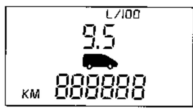
Dieser Wert wird nur angezeigt, wenn das Fahrzeug die Geschwindigkeit von 25 km/h überschreitet.
