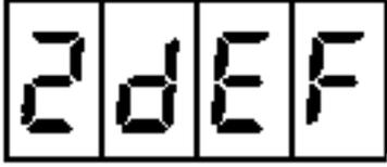
Dies zeigt an, daß das Steuergerät der Einspritzanlage wieder in seiner Ausgangsstellung ist.
