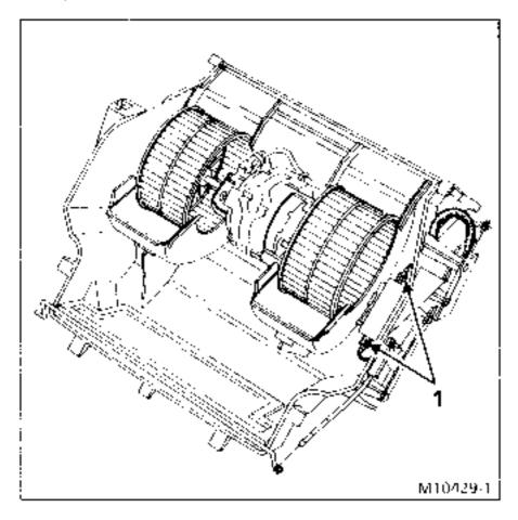
Wenn die Widerstände ausgebaut werden, weil sie beschädigt sind, unbedingt prüfen, ob das Heizungsgeblase frei dreht; es anderenfalls austauschen.
