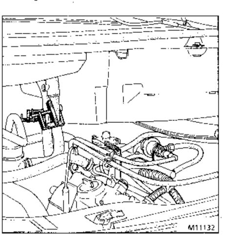
Die beiden Versorgungsschläuche des Wärmetauschers abziehen; zuvor die entsprechenden Schellen lösen.
