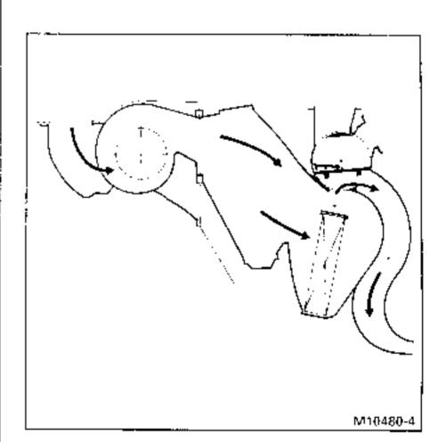
Der Luftstrom wird zu den Düsen für die Windschutzscheibenbelüftung, den Luftdüsen am Armaturenbrett und den hinteren und vorderen Sitzplätzen geleitet Der Luftstrom wird nur zu den hinteren und vorderen Sitzplätzen geleitet.
