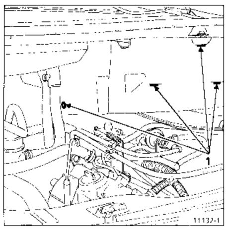
Die Stecker des Heizungsgeblases und der Widerstände an der Gebläseeinheit abziehen.
