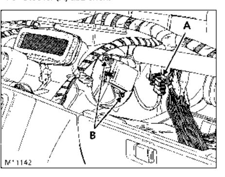
Die beiden Schrauben (B) lösen und den Motorausbauen.
