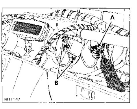
Dre beiden Schrauben (B) lösen und den Motorausbauen.
