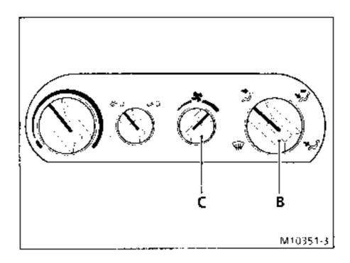
Die Luftmenge zum Fahrgastraum wird mittels Regler (C) bestimmt, der auf fünf verschiedene Geschwindigkeitsstufen eingestellt werden kann.
