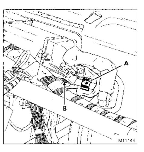
Die Mutter (B) lösen und das Thermostat ausbauen.
