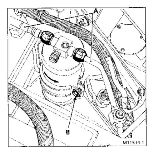
Die Schraube (B) losen und die Flasche nach oben herausnehmen.
