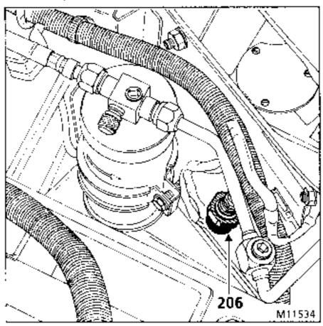
Arbeiten am Druckschalter können durchgeführt werden, ohne daß das Kaltemittelsystem vorher entleert wird; der Schalter befindet sich auf einem SKRADER-Ventil.
