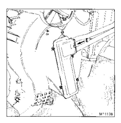
Die beiden Schrauben (F) des Haltebleches der Schläuche am Luftverteilergehäuse lösen.
