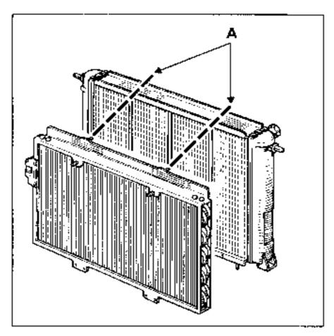
Die Einheit Kühlerventilator - Kondensator ausbauen.
