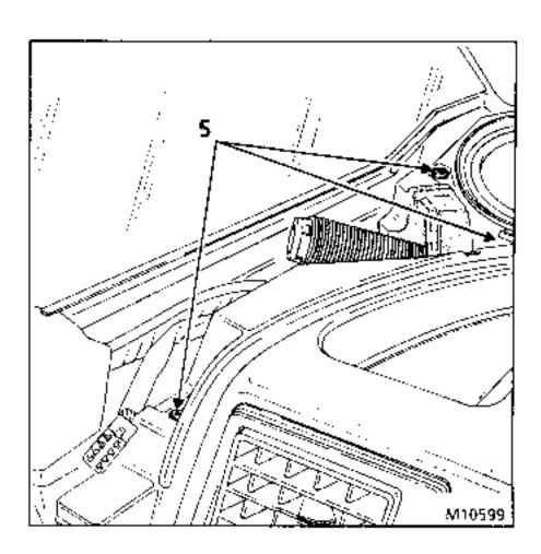
Die obere Partie des Armaturenbrettes anheben, die Bedienungseinheit lösen (hierzu aufdie Vorderseite drücken) und die obere Partie in den Fahrzeuginnenraum ziehen.
