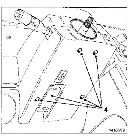
Die Befestigungsschauben des Bedienungssatelliten des Radios leicht lösen (je nach Ausführung).
