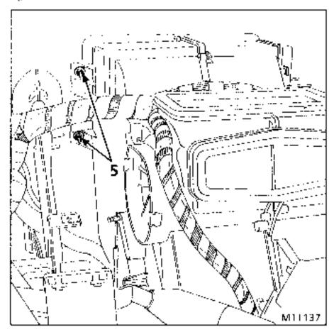
Den Stecker des Motors von der Luftverteilungstrommel abziehen und das Lufverteilergehäuse von den Bolzen der Stirnwand losen.
